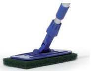
Padhalter mit Teleskopstiel Durch das Doppelgelenk ist der Padhalter in jede Richtung beweglich. Die Befestigung der Pads basiert auf dem Klettprinzip.
