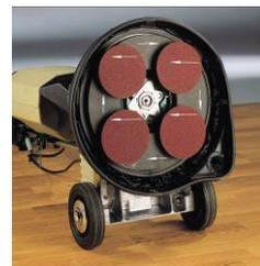
**Wahl des Schleifmittels** \_ Ziel ist ein scharfer, riefenfreier, feiner Schliff Körnung 120. Das Schleifergebnis hängt stark von der verwendeten Maschine ab und kann bei gleicher Körnung unterschiedlich ausfallen. Schleifpapiere haben bei gleichem Korn in der Regel einen gröberen Schliff als ein Schleifgitter gleicher Körnung.
